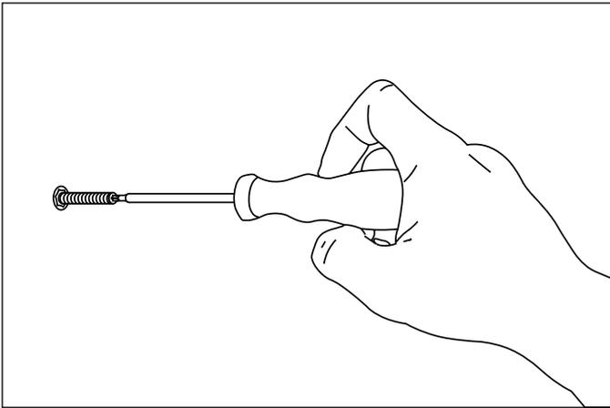
1. Die Position für das erste Element markieren. Ein Loch mit einem 8 mm Bohrer 55 mm tief bohren, dann den Dübel in das Loch stecken. Die Stockschraube mit 15er Torxschraubendreher bis zum Gewinde eindrehen.
