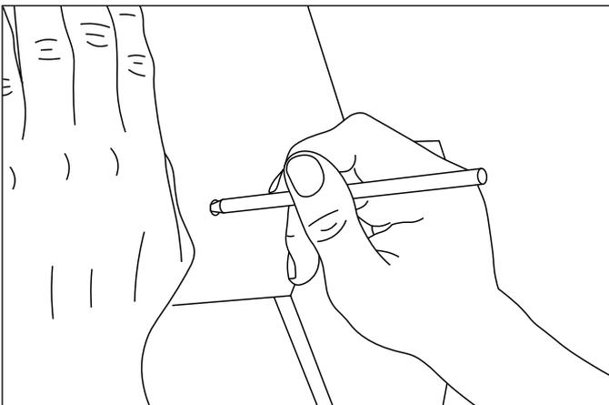
3. Nach Fixierung des ersten Elements das zweite Element an die dafür vorgesehene Stelle halten und die zweite Bohrungsstelle durch das Loch markieren und wie oben fortfahren.
